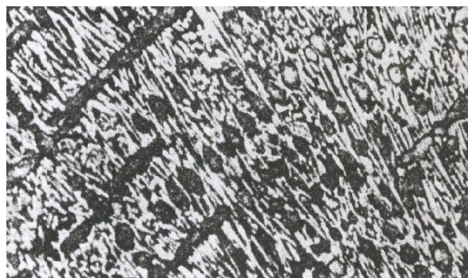
شکل ۳۵.۱۱-چدن پر کرم مقاوم در برابر سایش . دارای شبکه بین دندرنی کاربید آهن - کرم وطبیعت دندرنی شکل مارتنزیت . محلول اچ نایتال ۳ درصد بزرگنمایی ۱۰۰ برابر
